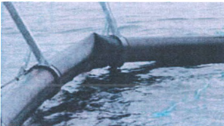
Bilde 5.1.1 Eksempel på sterk overbelastet flyterør med lokal bukling. Flyterørene behøver ikke være revet av eller lekk.
